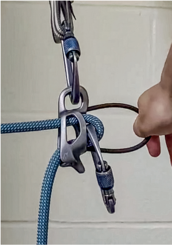
图2: 该图显示了既是在导向模式下，ATC的方向可能会使绳子在保护器里无制动力的通过。图片来源: Liu Yuezhang
