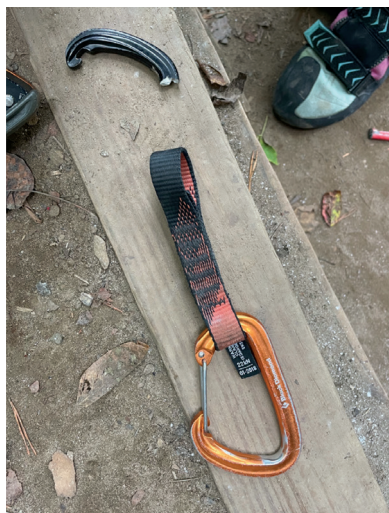
这个快挂的挂片端单锁在先锋冲坠时断裂，很可能是“锁鼻钩”处意外的钩住了一个化学螺栓杆。图片来源：1号攀登者
